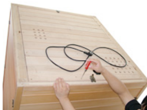
Obr.-23 Upevnite vonkajší horný kábel pomocou skrutiek
